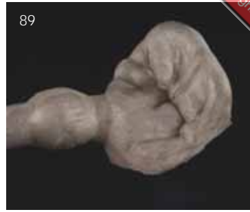
Abb. 87 bis 89 Die gepressten/ gegossenen und ausgebetteten Objekte werden mit 50 µm Glanzstrahl- perlen abgestrahlt
