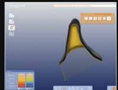
Abb. 36 bis 38 Die Stümpfe und die angefertigten Wachsgerüste wurden mit dem Scanner des Cercon Systems im Doppelscan digitalisiert. Danach werden in der CAD-Software die Parameter für Zirkonoxid-Kronen eingegeben. Da ich die Gerüstform händisch modelliert und per Doppelscan der Software quasi vorgegeben hatte, muss nun nur noch der markierte Raum (grün) aufgefüllt werden, um zu dem geplanten Ergebnis zu kommen
