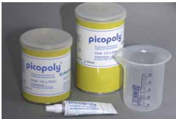
Abb. 6 Für die Steckstümpfe verwende ich wegen der hohen Kantenstabilität, Abrasionsfestigkeit und Dimensionstreue ein Modellstumpfmateriale auf Polyurethanbasis
