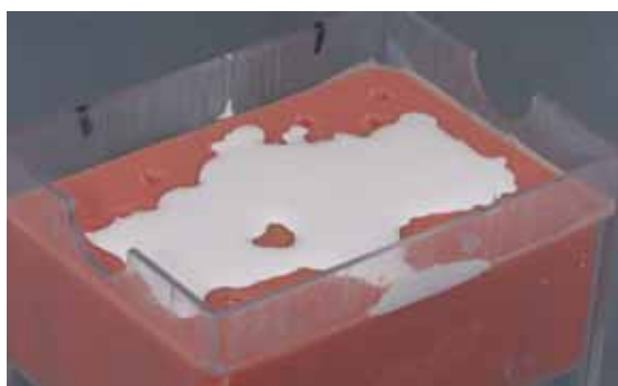
Abb. 10 und 11 Sobald das Dupliersilikon vernetzt ist, können der Bohrerständer und die Gipsstümpfe entfernt werden. Übrig bleiben die Hohlformen der Stümpfe, die mit dem bereits genannten Modellstumpfmateriale ausgegossen werden, das dann im Drucktopf eine Stunde lang polymerisiert wird
