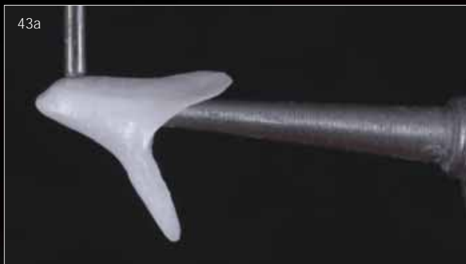
Abb. 43a und b Labial habe ich – um den benötigten Platz für die Verblendkeramik zu schaffen – die Zirkonoxid-Gerüste auf die Mindeststärke von 0,3 mm reduziert. Im nächsten Teil gehe ich auf die keramische Verblendung sowie die Seitenzahnversorgungen ein
