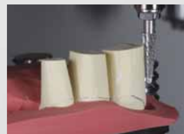
Abb. 5 Einen gleichmäßigen, der Angulation entsprechenden Konus erreiche ich, indem ich die Stümpfe mitsamt Konter in einen Vermessungstisch einspanne und dort den Winkel mit dem Fräsgerät anbringe
