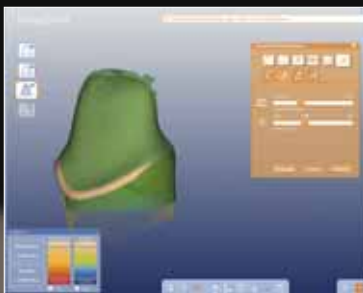
Abb. 36 bis 38 Die Stümpfe und die angefertigten Wachsgerüste wurden mit dem Scanner des Cercon Systems im Doppelscan digitalisiert. Danach werden in der CAD-Software die Parameter für Zirkonoxid-Kronen eingegeben. Da ich die Gerüstform händisch modelliert und per Doppelscan der Software quasi vorgegeben hatte, muss nun nur noch der markierte Raum (grün) aufgefüllt werden, um zu dem geplanten Ergebnis zu kommen
