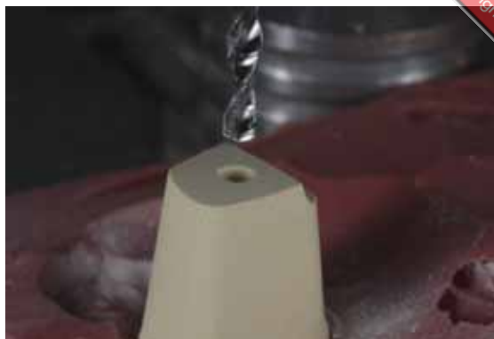
Abb. 7 Um die Gipsprototypen der Steckstümpfe auf das Modellstumpfmateriale zu übertragen, bohre ich mit dem Fräsgerät in die Stumpfböden Löcher, in die die Pins eingeklebt werden
