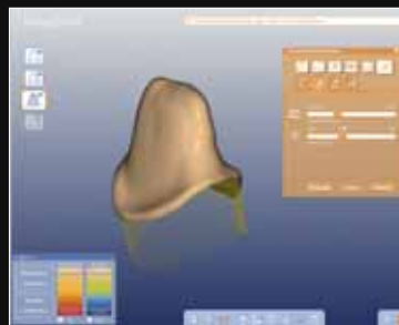
Abb. 36 bis 38 Die Stümpfe und die angefertigten Wachsgerüste wurden mit dem Scanner des Cercon Systems im Doppelscan digitalisiert. Danach werden in der CAD-Software die Parameter für Zirkonoxid-Kronen eingegeben. Da ich die Gerüstform händisch modelliert und per Doppelscan der Software quasi vorgegeben hatte, muss nun nur noch der markierte Raum (grün) aufgefüllt werden, um zu dem geplanten Ergebnis zu kommen
